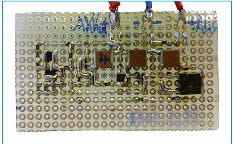
durch R9 kein Strom mehr, weshalb das Gate von T1 über R8 auf  $U_B$  gezogen wird und T1 somit abschaltet. Damit es nun nicht zu einem permanenten Ein- und Ausschalten kommt, wenn  $U_B$  aufgrund der fehlenden Last wieder etwas steigt, ist mit R12 für eine Hysterese von etwa 1 V gesorgt. Die Last kann daher
