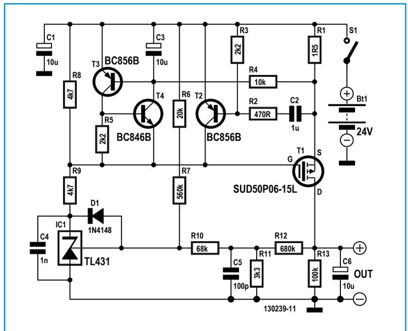
Ist der Öffner S1 geschlossen (Normalbetrieb) und noch keine Last eingeschaltet, dann ist T1 durchgeschaltet, da das etwas zweckentfremdete IC1 bei ausreichend hoher Akkuspannung an seiner Kathode Strom fließen lässt und so das Gate von T1 über R9 auf Masse zieht. Am Ausgang liegt daher Spannung an.
