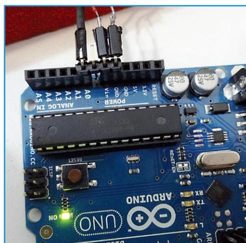
Bild 1. Anschluss des Sensors an das Arduino-Board.
