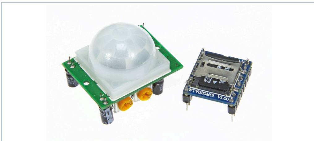
Bild 2. Das Geräusch-Modul und das PIR-Näherungssensor-Modul.
