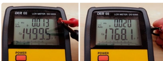
Bild 4. Diese Referenz-Kondensatoren von 1nF haben abweichende Werte.
