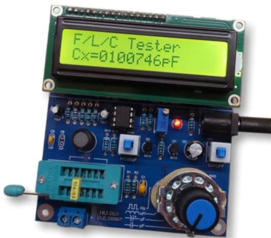
Bild 5. Mit einem geeigneten Referenz-Kondensator erhalten wir brauchbare Messwerte.
