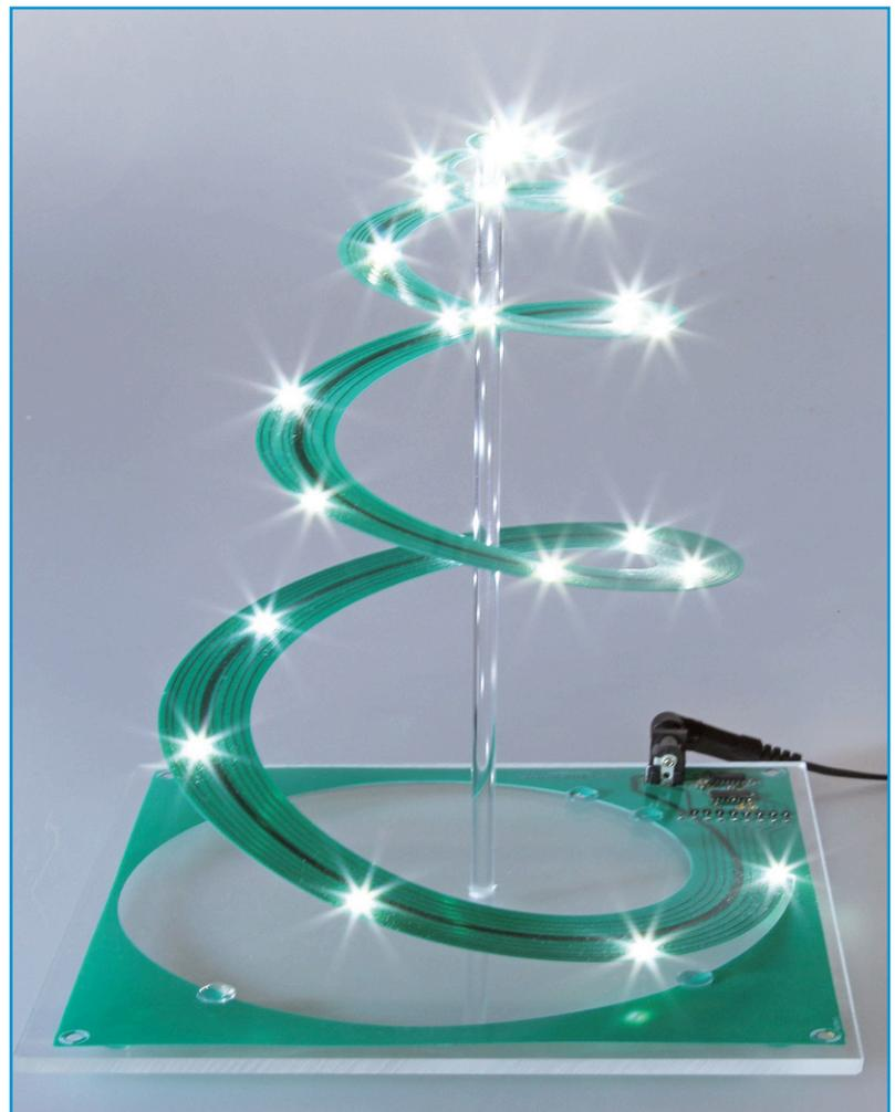
aus drei zusammenschalteten SMD-LEDs bestehen. In **Bild 1** ist die Schaltung skizziert. Der erste versuchsweise aufgebaute Zufallsgenerator war mit nur einem 4-bit-Schieberegister bestückt, zwei Schieberegister-Ausgänge waren über EXOR-Gatter rückgekoppelt. Diese Konfiguration lieferte 16 Bitmuster, wovon das Muster „0000“ ausfällt, denn mit ihm läuft der Zufallsgenerator ins Leere. Der visuelle
